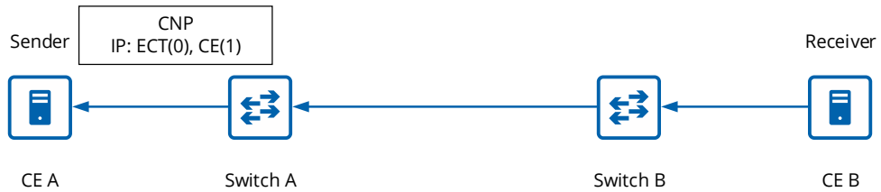
图 3-7 发送服务器收到 ECN 标记为 01 的 CNP 报文解析后对相应的数据流限速算法
