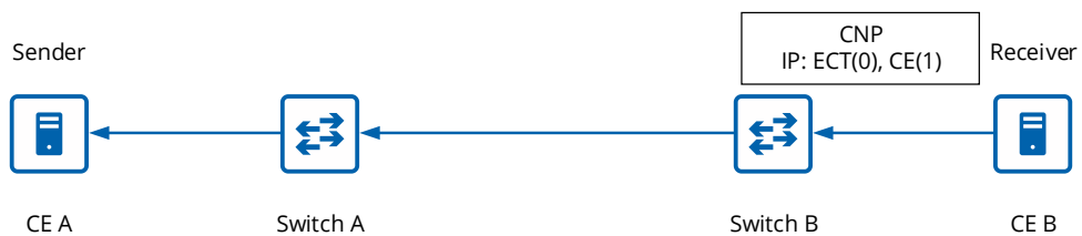
图 3-5 接收端产生拥塞通告，周期发送 CNP (Congestion Notification Packets) 报文，ECN 字段为 01，要求报文不能被网络丢弃
