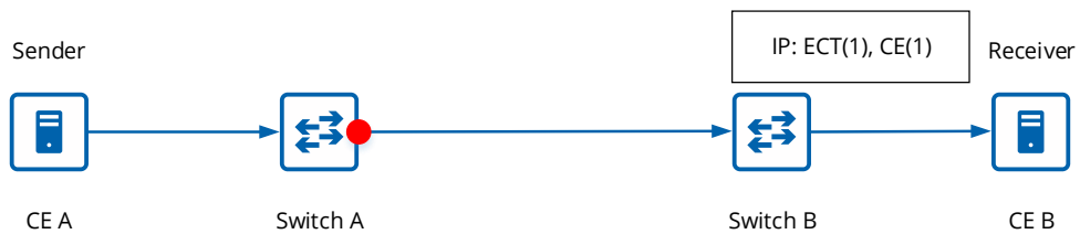
图 3-4 接收服务器收到 ECN 为 11 的报文发送拥塞，正常处理该报文
